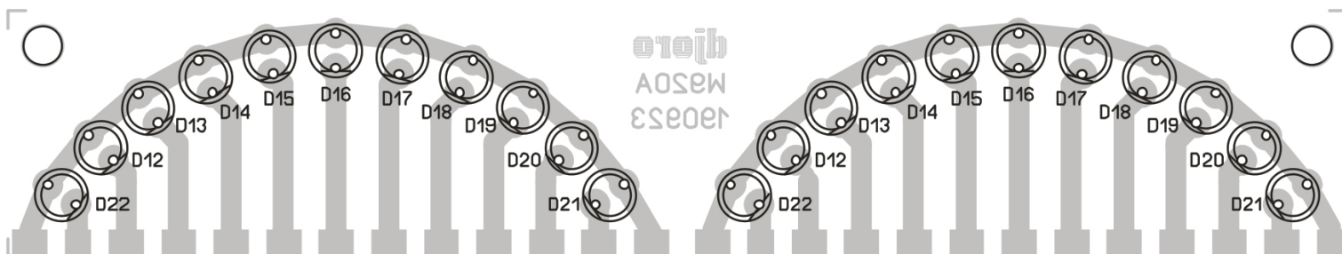
obr. 3. Osazovací plán desky LED diod
